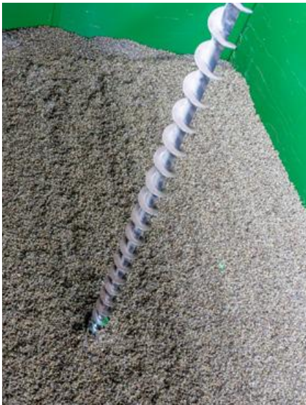
Container-Trocknung mit automatischem Rührwerk und doppeltem Boden.
