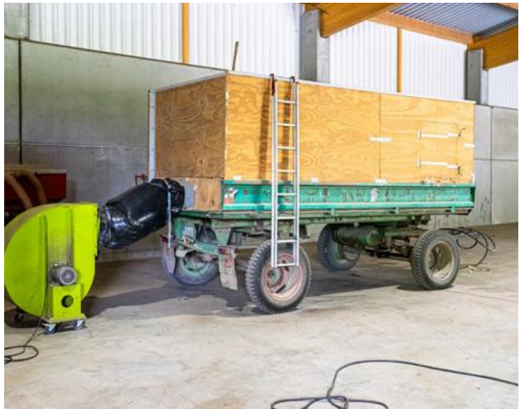
Wagentrocknung mit doppeltem Boden. Für eine gleichmäßige Trocknung ist das tägliche Umschaufeln von Hand notwendig.
