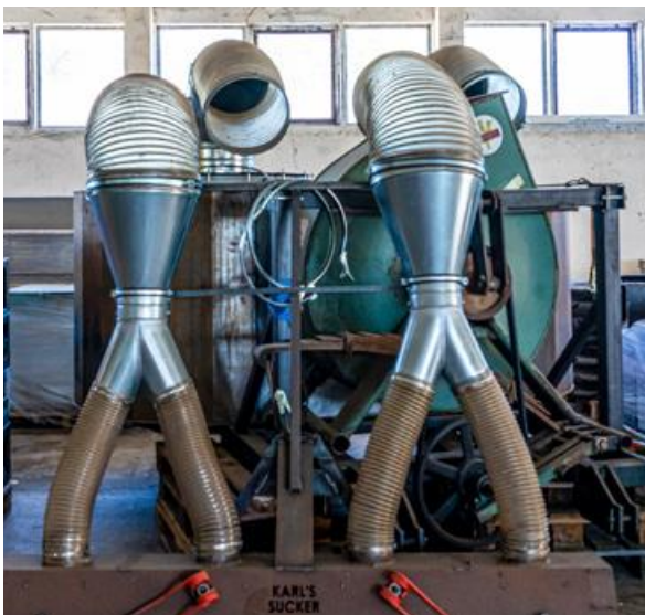
„Marke Eigenbau“: umkonstruiertes Sauggerät für die Ernte von Korbblütlern.
